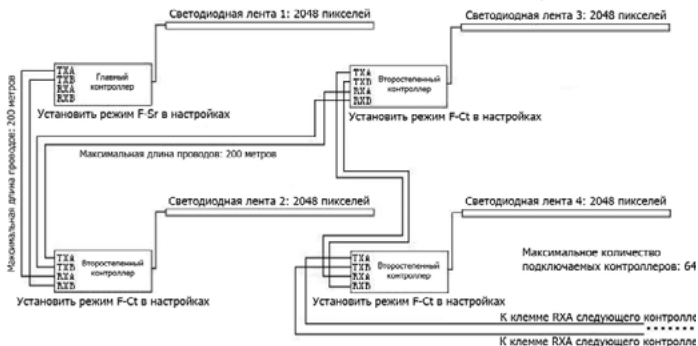
Рис.5. Подключение при синхронной работе нескольких контроллеров.
